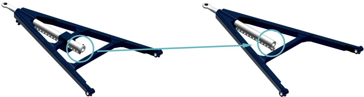
Anstelle der bisherigen BNA Zugöse 29.05804 ist künftig bei den längeneinstellbaren Zuggabeln PZL 27, PZL 32 und PZGL 32 eine anschraubbare BNA Flanschzugöse (29.05917 oder D50-C) anzubringen, welche vom Fahrzeughersteller beigestellt und montiert wird.
