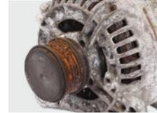
Korrodiertes Ritzel und korrodierte Riemenscheibe
