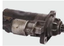
Stark deformiertes Gehäuse
