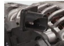
Beschädigung des Steckers bis unterhalb des Dichtrings
