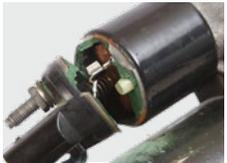
Beschädigung am Plastikteil des Einrückrelais
