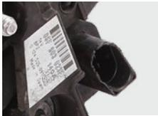
Beschädigung des Steckers bis zur Dichtlippe
